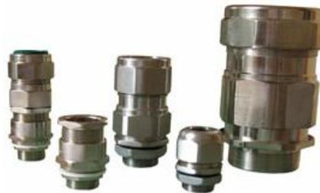
Вводы кабельные применяются в электрооборудовании, предусматривающем дополнительное закрепление кабеля, при его прокладке. Вводы кабельные предназначены для применения во взрывозащищенном электрооборудовании I и II групп в соответствии с ГОСТ Р 51330.0-99.
