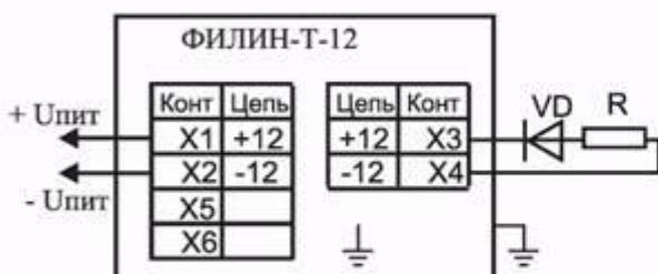
Диод VD и резистор R рекомендуется устанавливать для контроля цепи шлейфа обратным напряжением. Тип диода и номинал резистора подбираются потребителем. X5 и X6 - свободные клеммы для нужд потребителя
