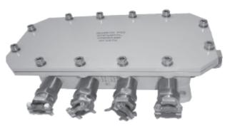
Прямоугольный корпус коробки закрыт крышкой, которая крепится к корпусу двенадцатью винтами. На боковых поверхностях корпуса может быть расположено до 10 кабельных вводов. Коробка крепится на стену болтами через четыре отверстия, расположенные на корпусе.
